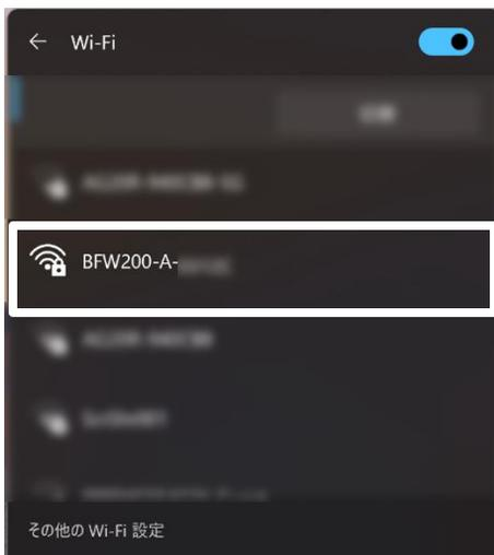
【3-1.無線設定の事前準備】で確認した接続したい無線親機のSSIDを選択します。
